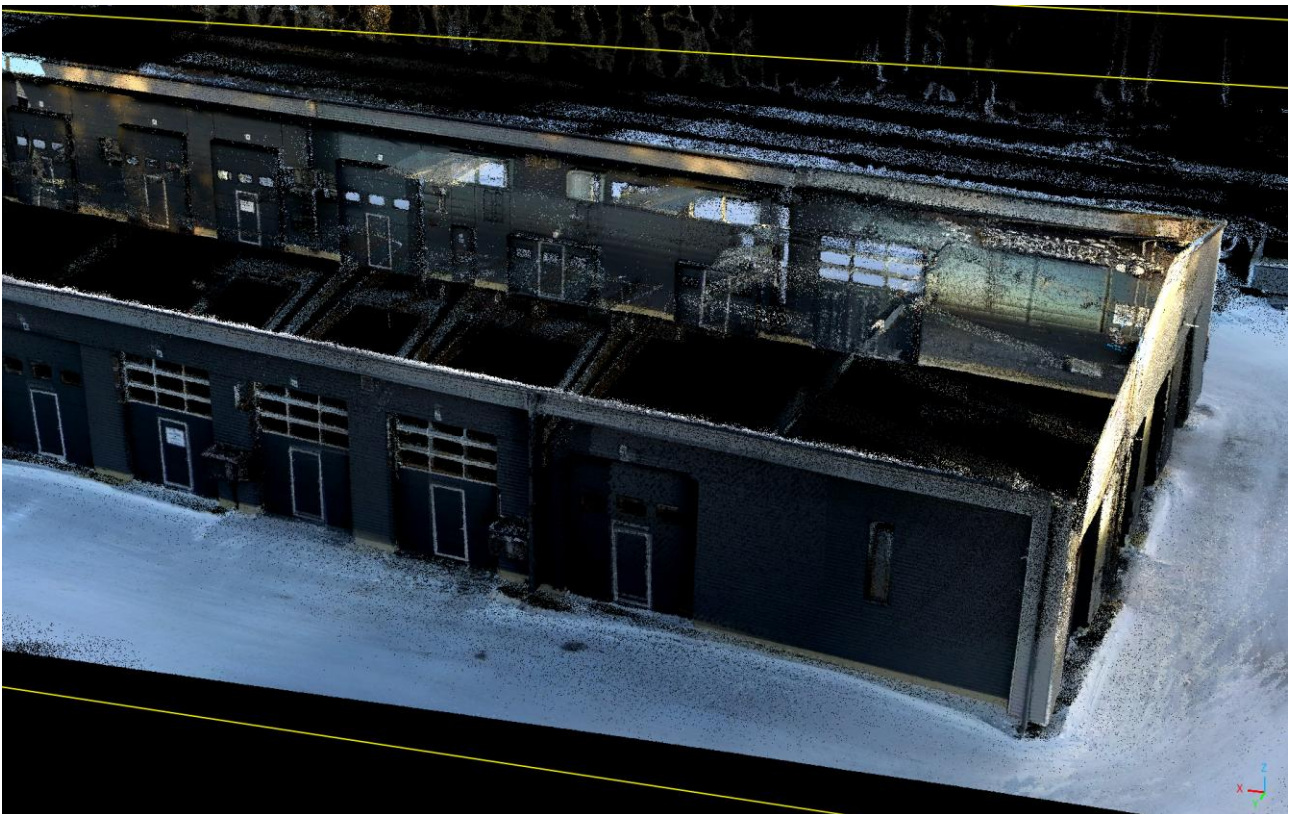
Kuva 6. Talliosake takasivulta esitettynä Trion Modelissa väritettynä pistepilvenä.
