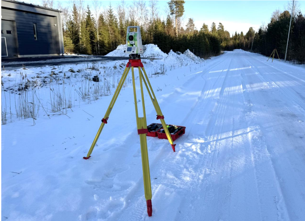
Kuva 9. Takymetrimittauksessa käytetty Alpha Ti-takymetri Leica-kolmijalalla ja taustalla GMP104-prisma samanlaisella kolmijalalla.
